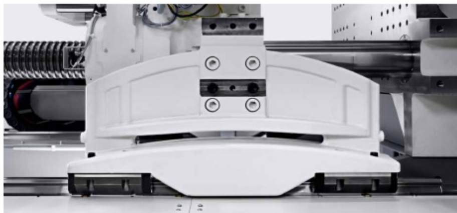
Wózek GuideX absorbuje siły, chroniąc tym samym prowadnice liniowe. Dzięki temu poruszają się one lekko przez cały czas użytkowania.
