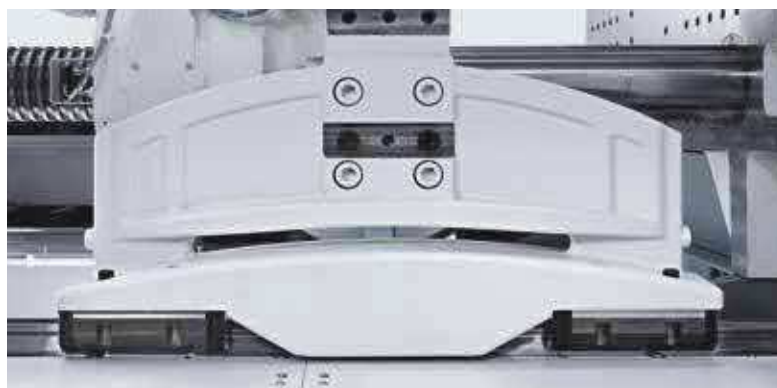
Wózek GuideX absorbuje siły, chroniąc tym samym prowadnice liniowe. Dzięki temu poruszają się one lekko i precyzyjnie przez cały okres użytkowania.
