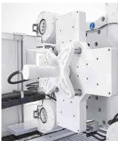
Obszerna strefa wyrzutnika jest idealna do specjalnych konstrukcji wyrzutnika i stołów obrotowych
