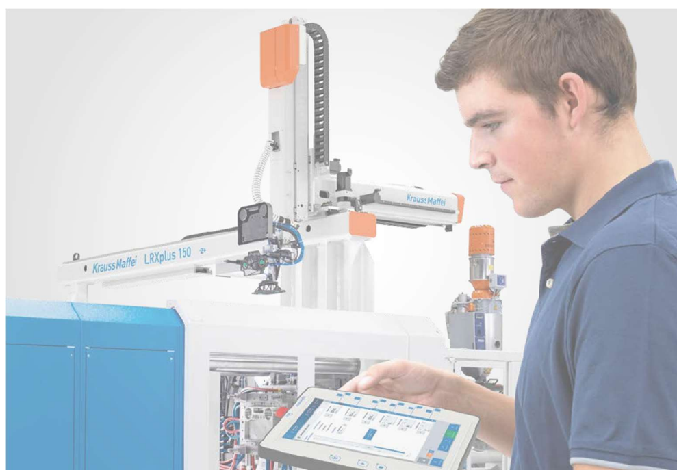
Nowy, ergonomicznie zoptymalizowany ręczny panel sterowania z ekranem dotykowym do wygodnego programowania i konfiguracji robota liniowego LRXplus
